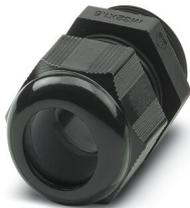
Kabelverschraubung, Material Verschraubung: PA, Kabelaußendurchmesser 18 mm ... 25 mm, Schirmung: nein, Anschlussgewinde: M32 x 1,5, Farbe: tiefschwarz RAL 9005
