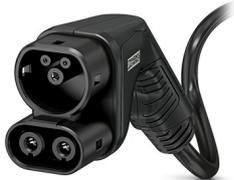
CHARX connect, DC-Ladeleitung mit Fahrzeug-Ladestecker und offenem Leitungsende, Gehäusefarbe schwarz, mit angeschlossenem PP-Kontakt, zum Laden mit Gleichstrom (DC) von Elektrofahrzeugen (EV), zur Installation an Ladestationen für die Elektromobilität (EVSE), Combined Charging System, CCS Typ 2, IEC 62196-3, 80 A / 1000 V (DC), C-Line, "PHOENIX CONTACT"-Logo, Kabel: 5 m, schwarz, gerade
