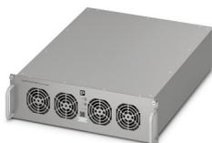
CHARX power, Schnelllademodul für den Aufbau von DC-Ladestationen, 19"-Rack-Montage, CAN-Bus, Ausgang: 150 V DC...1000 V DC / 0 A...100 A
